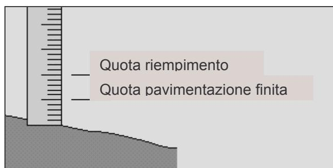
Inserire un elemento verticale nel vano porta (pannello in fibre di legno o asse di legno opportunamente svincolata dalla struttura del solaio sottostante con materiale resiliente), verso l'interno della camera, alto almeno quanto l'altezza del riempimento stagiato (vedi Figura c), in modo tale che il materiale rimanga in sede.
