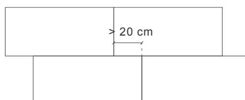
Nel caso di locali con dimensioni superiori ai 20 m è necessario prevedere giunti di dilatazione. Per locali stretti (corridoi) la posa delle lastre deve essere effettuata in direzione longitudinale.
